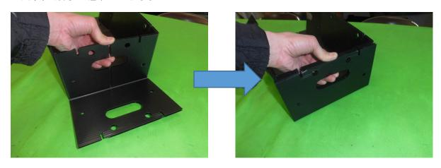
3.左右の丸穴をパンロックで固定します。写真のよう押し込みます。
